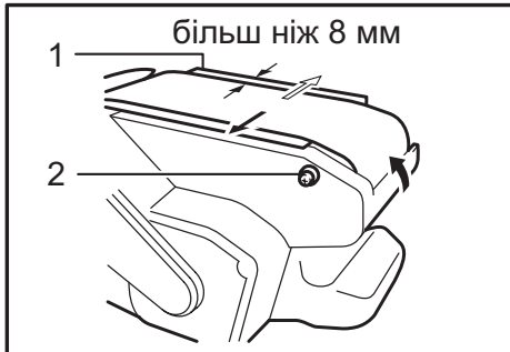
1. Сталева пластина 2. Гвинт регулювання
